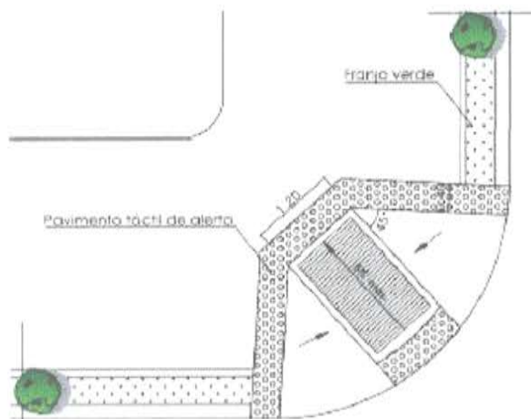
Rampa de esquina
